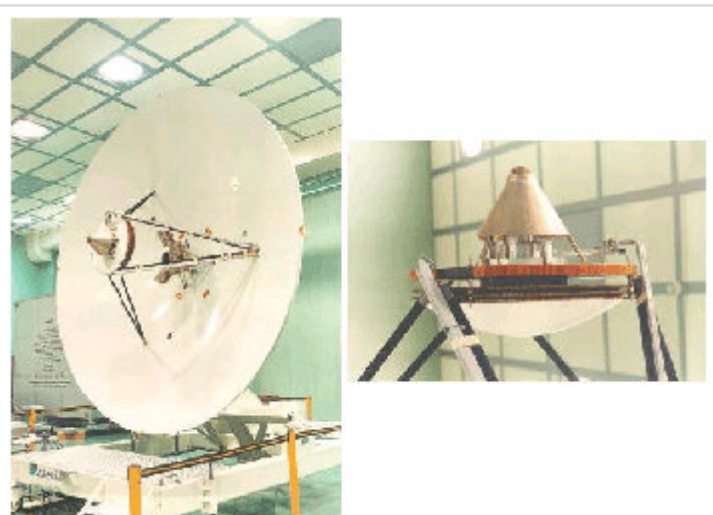
Obr. 6.2 Celkový pohled na anténu pro družici Cassini 96 (vlevo). Detail hyperbolického subreflektoru této antény (vpravo).
