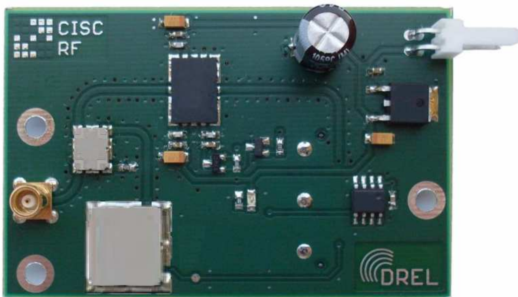
Obr. 1: RFID zásuvný modul pro RF rozhraní
