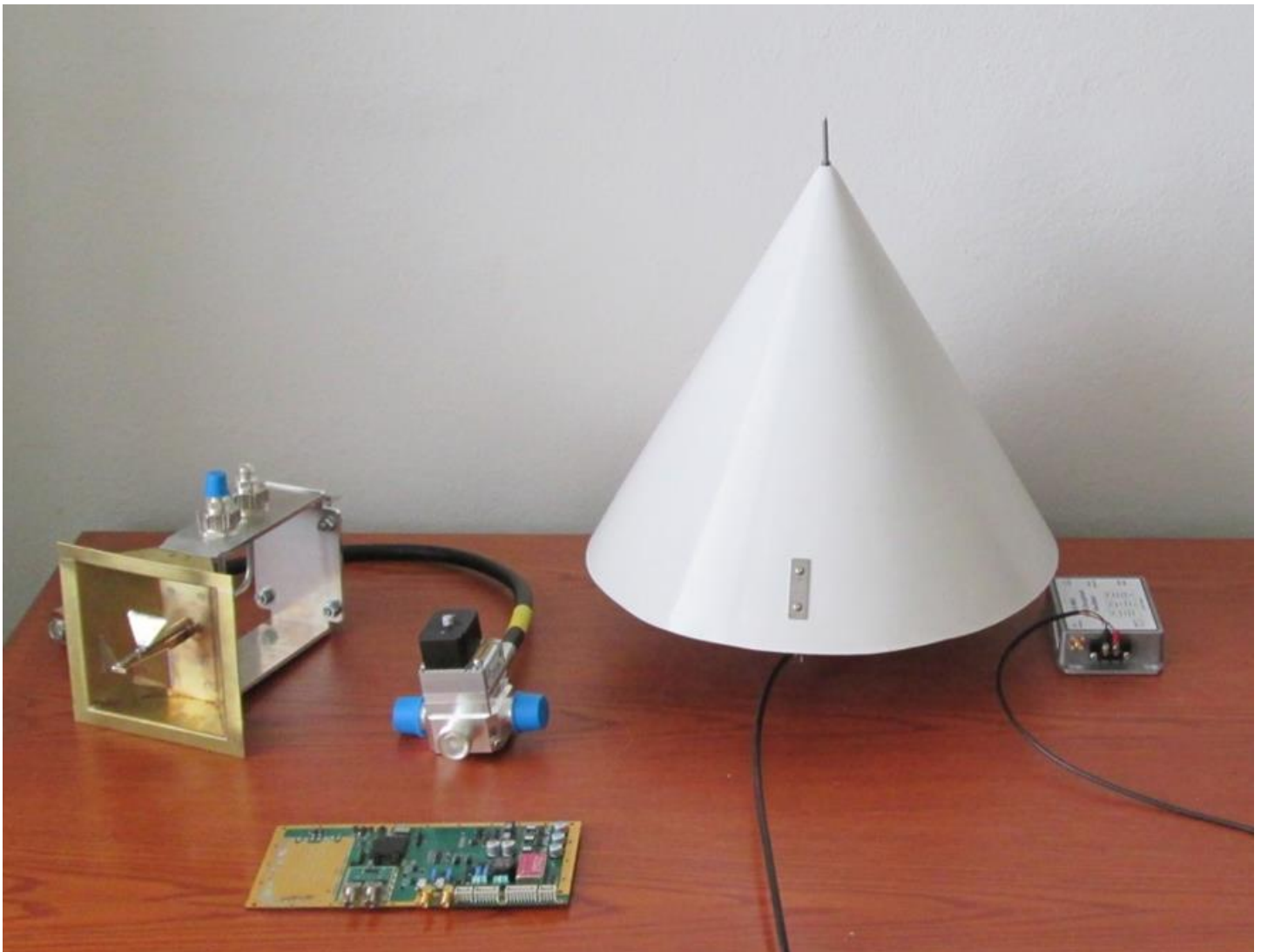
Obr. 1: Prototyp přijímače multistatického radaru
