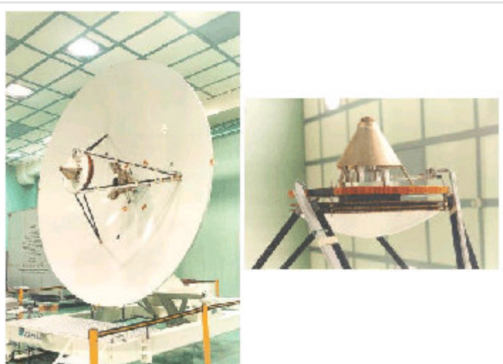
Obr. 6.2 Celkový pohled na anténu pro družici Cassini 96 (vlevo). Detail hyperbolického subreflektoru této antény (vpravo).
