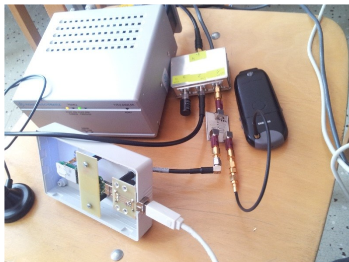
Obr. 2: Zkoušení GSM děliče – současné spojení hovoru a přenos dat přes LTE
